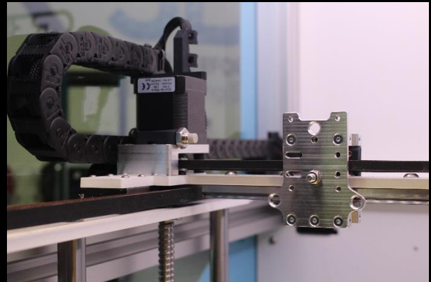
Linear-Einheit und Multifunktions-Druckkopfaufnahme
