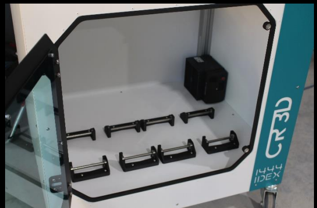
Beheizte Filament-Station mit Abroller für 2x 10kg Rollen
