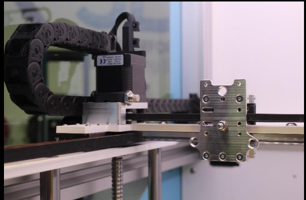
Linear-Einheit und Multifunktions-Druckkopfaufnahme
